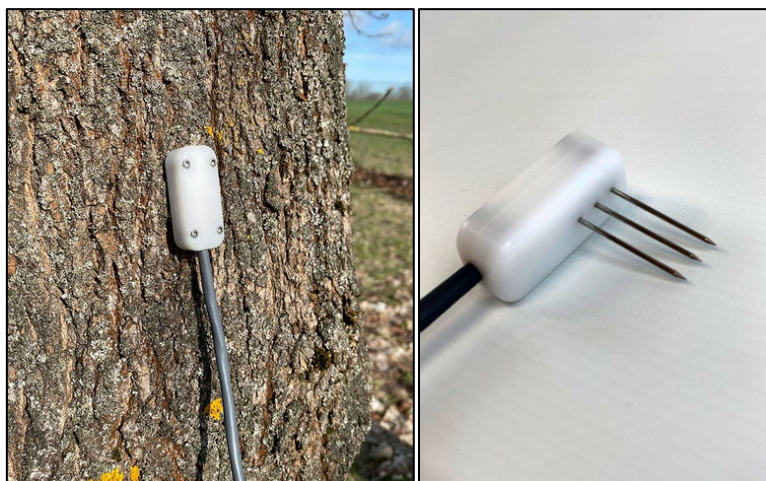
Figura 9. Detalle del sensor flujo de savia propuesto para estimar la transpiración (modelo UGT SFM-4 Sensor) (Fte.: UGT, Umwelt-Geräte-Technik GmbH).
