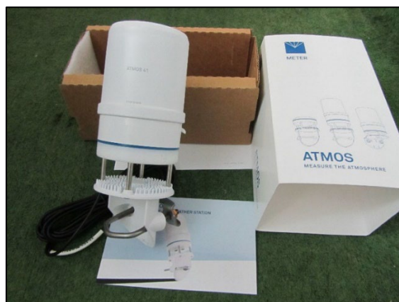
Figura 8. Detalle de una estación climática completa para la medida de doce variables simultáneamente. Su diseño compacto y su protocolo de comunicación SDI-12 permiten que se pueda programar y descargar la información gracias a la conexión con un sistema de adquisición de datos centralizado.
